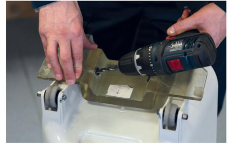
Plantilla de taladrado PolyJet que utiliza un cojinete de taladrado para una colocación precisa y repetible del orificio.
