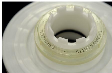
Calibre para roscas impreso en 3D mediante PolyJet que se utiliza para comprobar que la rosca es correcta en una pieza fabricada por Rutland Plastics.
