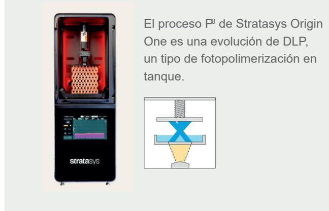
El proceso P<sup>3</sup> de Stratasys Origin One es una evolución de DLP, un tipo de fotopolimerización en tanque.
